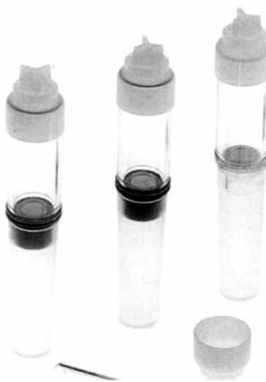
tion-Membran verwendet wird, werden Ausbeuten von mehr als 90 % erreicht. Der Einsatz erfolgt für die Konzentrierung und/oder Entsalzung von proteinhaltigen Lösungen und für das Auswaschen von Primern aus PCR-Proben.
