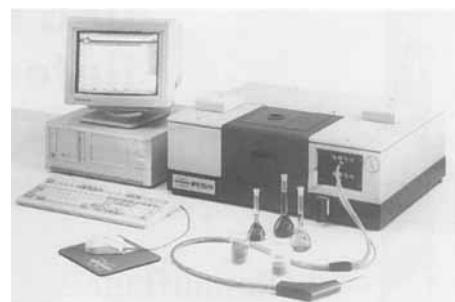
skops, für chromatographische Kopplungen und für einen FT-Raman-Zusatz stehen bis zu fünf Strahlausgänge und bis zu vier Eingänge zur Verfügung. Zur Standardausstattung gehört eine Datenstation mit PC, über die sämtliche Funktionen des Spektrometers gesteuert werden. Die Software „Opus“ erleichtert die Arbeit.
